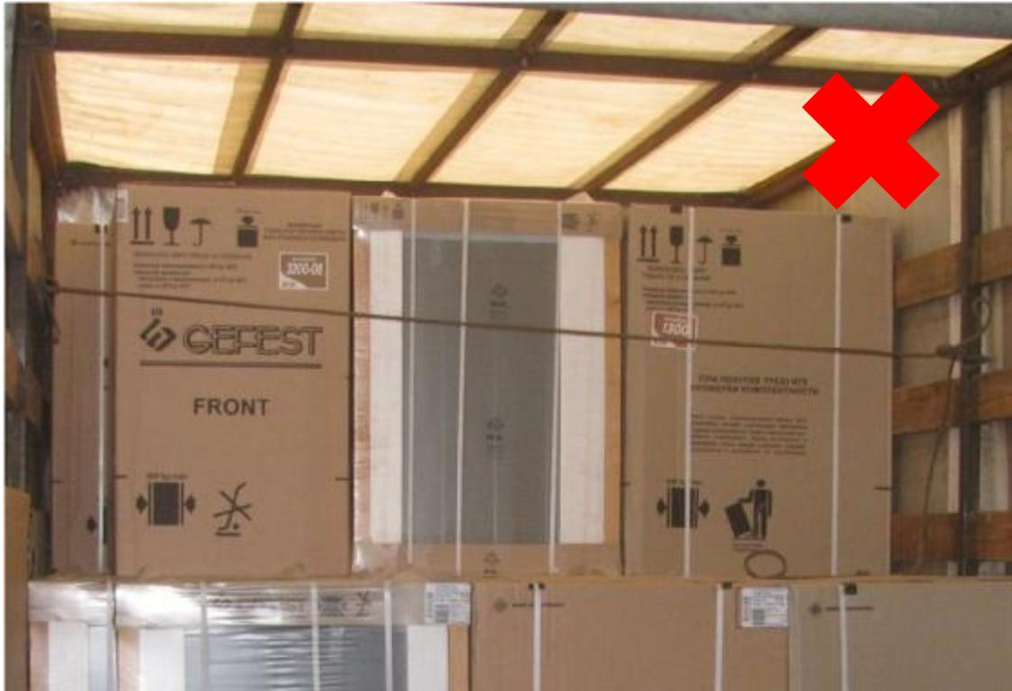
Средства крепления должны плотно прилегать к изделиям. Крепежные ремни устанавливать так, чтобы они не перекручивались, не провисали и обеспечивали опору груза на полную ширину. Не допускается завязывать ремни в узел.
