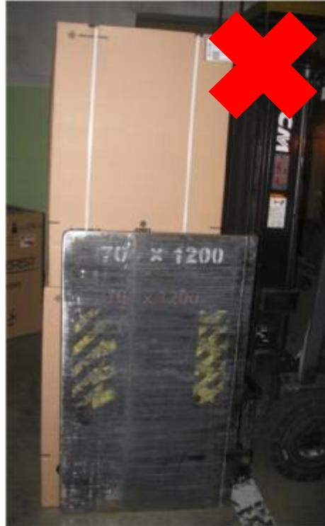
При перемещении посудомоечных машин механизированным погрузчиком захват осуществлять от основания изделия согласно манипуляционным знакам:
