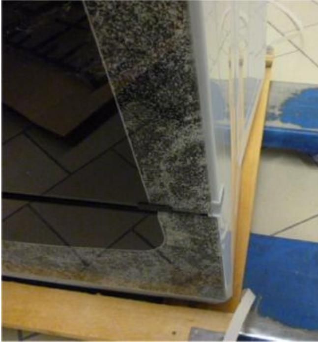
**несоблюдение п.4.2.11.** При проведении погрузочно разгрузочных работ произошел удар плиты об опорную поверхность.
