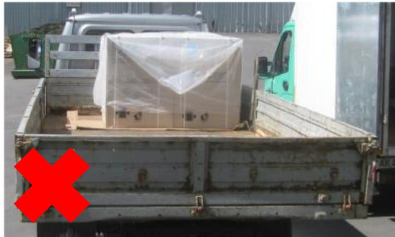
Тент бортовой платформы и кузова-фургона не должен иметь повреждений, разрывов и должен быть надежно закреплен.
