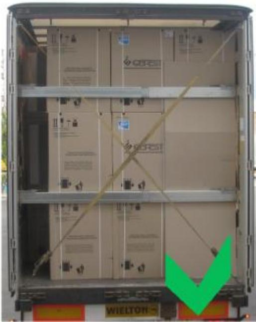
Примечание: Данные схемы крепления (см. иллюстрацию выше) допускается применять при установке уплотнительных элементов в зазоры между изделиями и бортами кузова.
