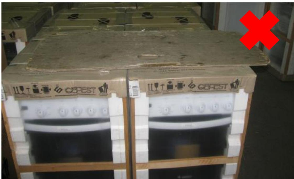
4.2.3 Перемещать упакованное изделие с помощью тележки следует только при симметричном расположении груза относительно ее опорной поверхности.
