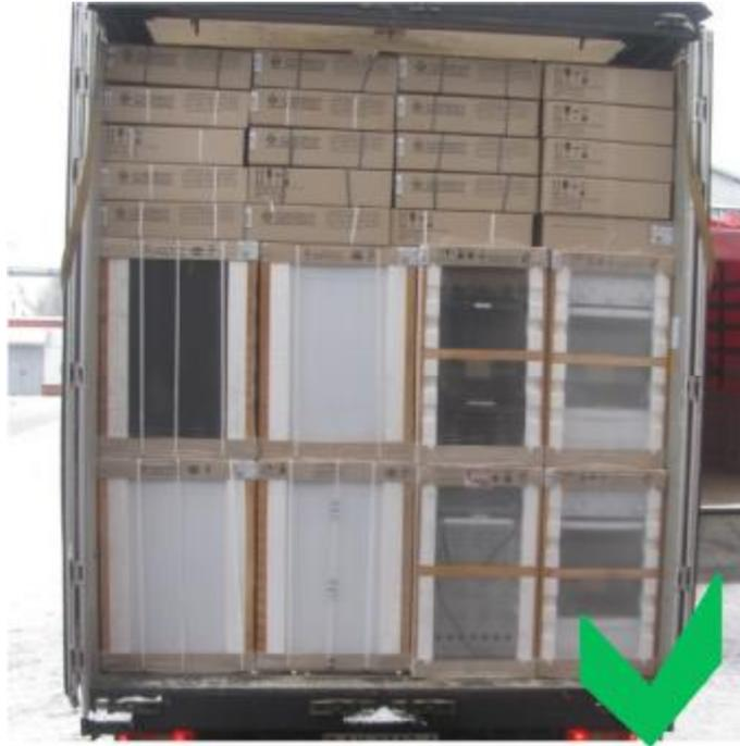
При образовании зазоров в свободное пространство установить уплотняющие элементы: картон, деревянные распорки, воздушные пакеты (пневмооболочки) и др. средства, обеспечивающие целостность и сохранность груза при транспортировке. Воздушные пакеты должны свободно становиться в пространство между изделиями, не допускается деформация упаковки от воздушного пакета.
